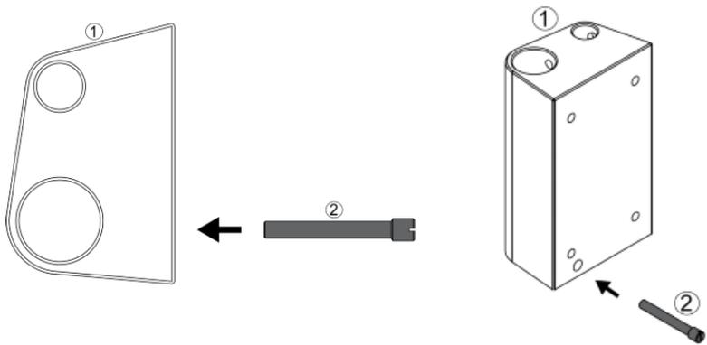
Der Zubehörhalter wird durch die Bettseite hindurch verschraubt. Beidseitig an den Bettseiten befinden sich Vorbohrungen. Mit einer spitzen Nadel die Polsterung an der Stelle der Vorbohrungen durchstechen. Auf der Innenseite der Box sind die Stellen der Vorbohrungen durch quadratische Abheftungen mit Klammern ersichtlic.
